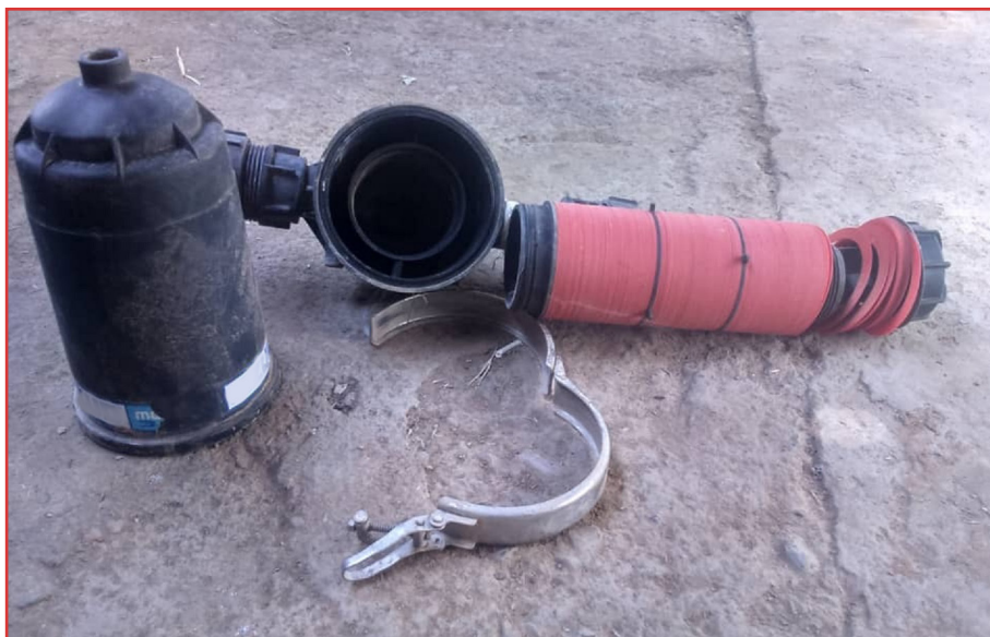
شکل ۹- فیلتر دیسکی مورد استفاده در آبیاری قطره‌ای
