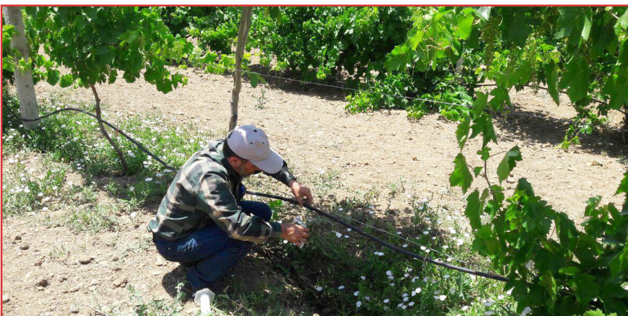
شکل ۴- اندازه‌گیری دبی قطره‌چکان‌ها در آبیاری قطره‌ای
