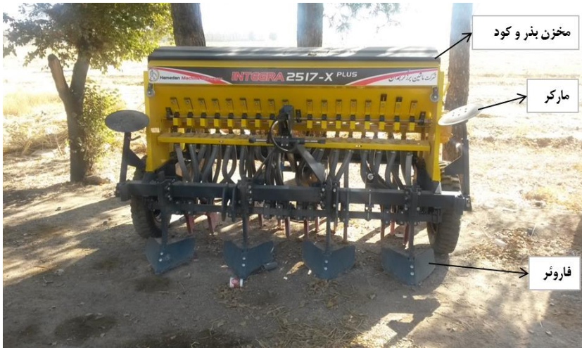
شکل ۳- دستگاه خطی کار کف کار با عرض جویچه ساز ۶۰ سانتی متر (از جلو)
