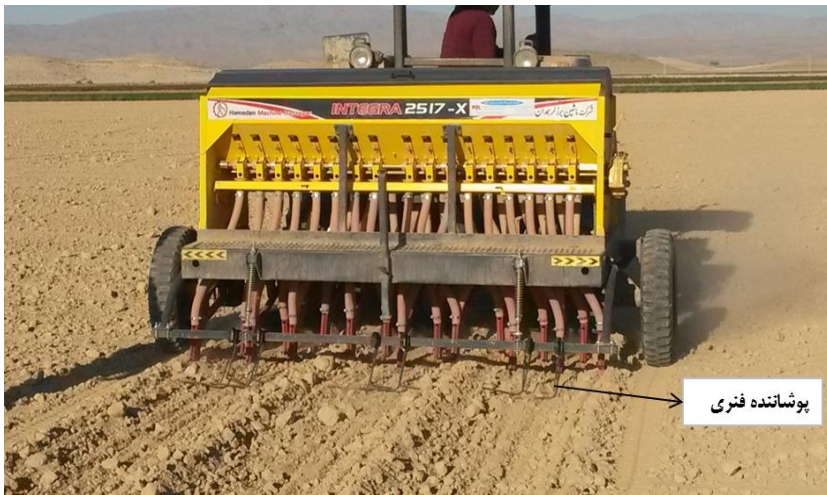
شکل ۴- دستگاه خطی کار کف کار (از پشت)
