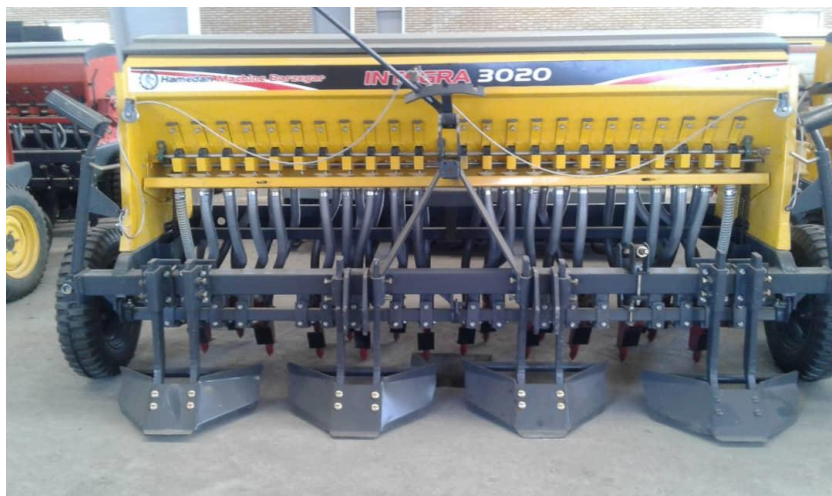
شکل ۲- دستگاه خطی کار کف کار با عرض جویچه ساز ۷۵ سانتی متر
