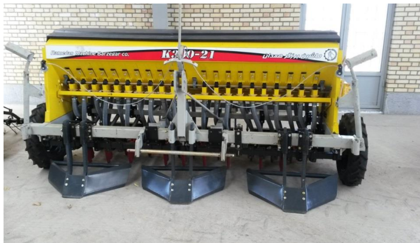
شکل ۱- دستگاه خطی کار کف کار با عرض جویچه ساز ۱۰۰ سانتی متر
