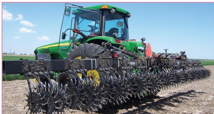
شکل ۴- کولتیواتور ستاره ای (لیلستون) (انجام عملیات دفع علف های هرز و سله شکنی سطحی خاک)
