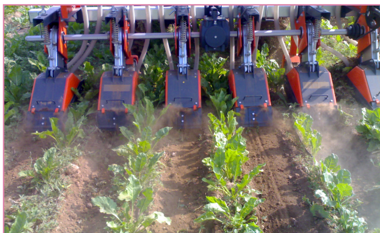
شکل ۱۲- وضعیت علف‌های هرز با روتیواتور بین ردیفی
