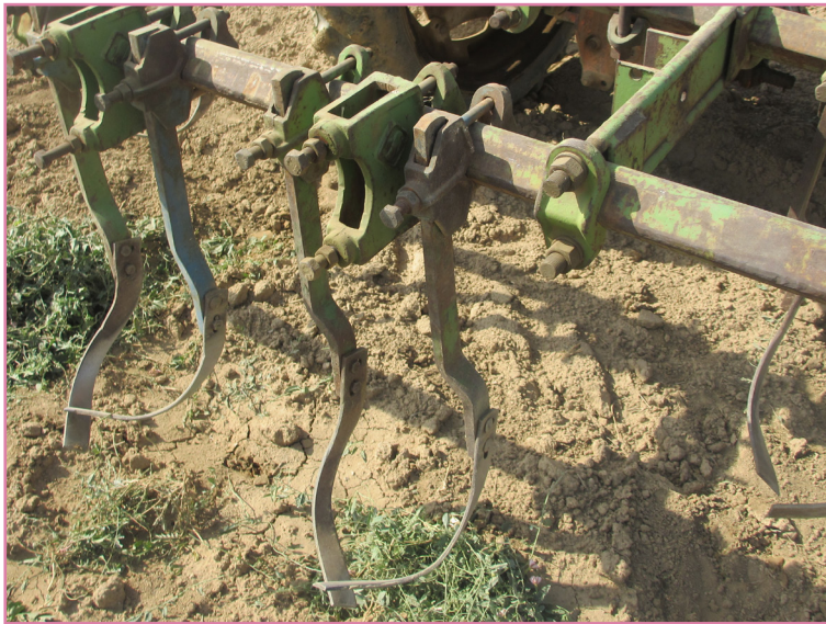
شکل ۳- کولتیواتور تیغه شمشیری (انجام عملیات دفع علف‌های هرز و سله‌شکنی سطحی خاک)
