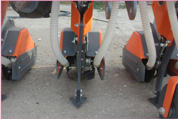
شکل ۸- روتیواتور ردیفی مجهز به کودریز و خاک‌ورز (انجام عملیات دفع علف‌های هرز، کوددهی و خاک‌ورزی بین ردیف‌ها)
