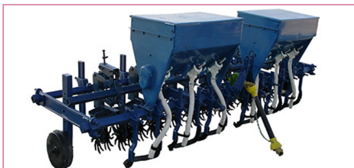
شکل ۶- کولتیواتور تیغه شمشیری مجهز به کودریز و تیغه های چرخان ستاره ای (انجام عملیات دفع علف های هرز، کوددهی، سله شکنی، شکل دهی جویچه ها و خاک دهی پشته ها به طور هم زمان)
