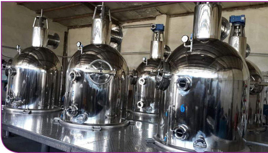
شکل ۶- سامانه دوجداره تغلیظ آب توت از جنس استیل ضد زنگ و تحت خلأ
