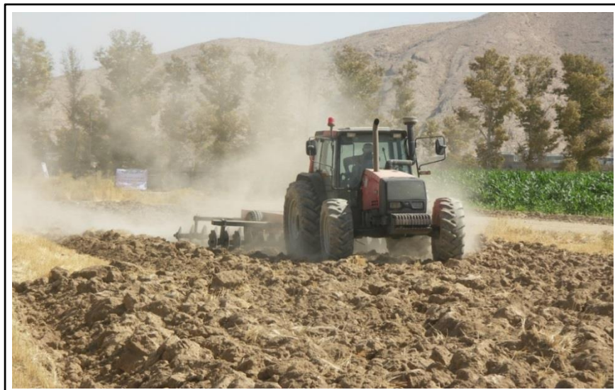
شکل ۴- کلوخه ایجاد شده به وسیله گاواهن برگردان دار
