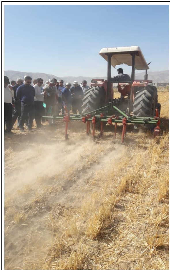
شکل ۷- قابلیت کارکرد خاکورز کج ساق با تراکتور سبک چهار سیلندر در مزرعه
