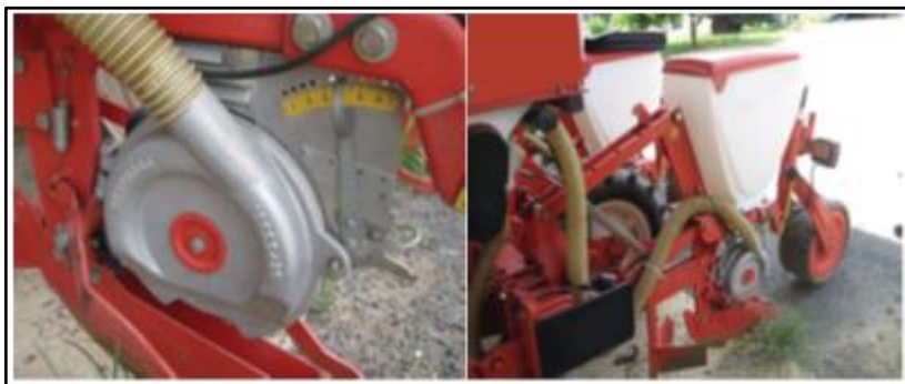
شکل ۹- دستگاه اندازه گیری بذر (موزع)
