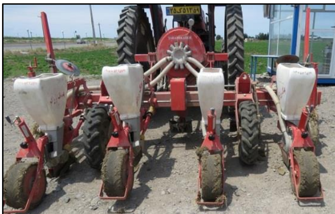
شکل ۳- بذرکار پنوماتیک برای کاشت بادام زمینی
