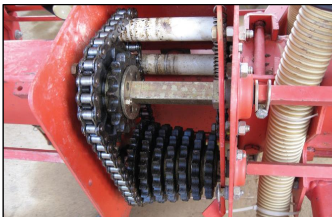
شکل ۵- جعبه دنده یک بذرکار پنوماتیک گاسپاردو برای کاشت بادام زمینی
