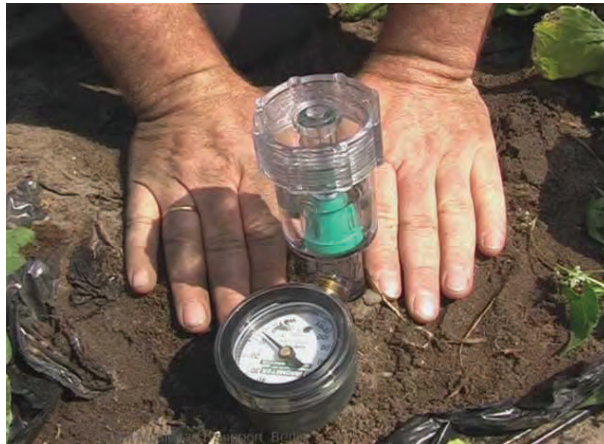
شکل ۱۳. نحوه قرار دادن تانسیومتر در خاک
