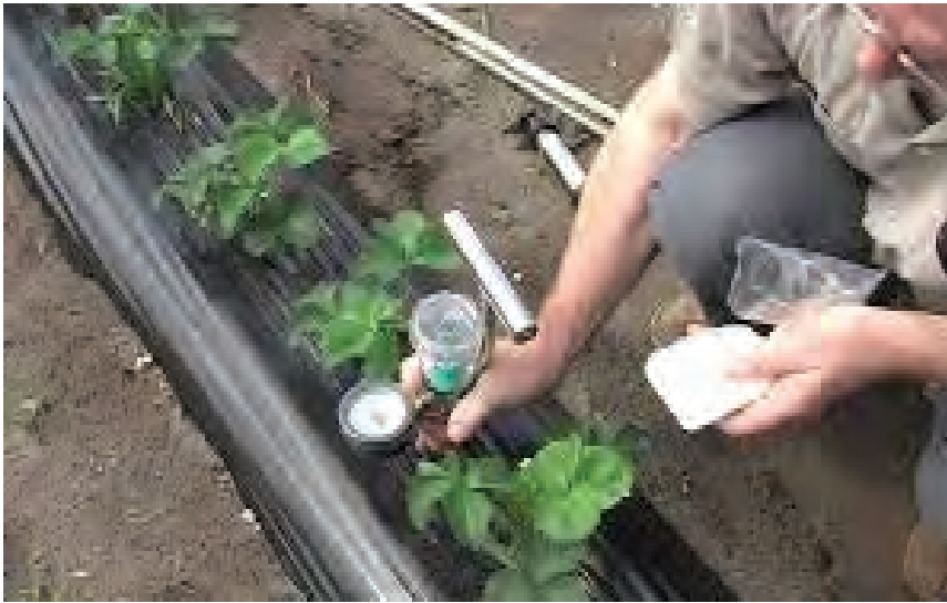
شکل ۱۷. نحوه خروج تانسومتر از خاک
