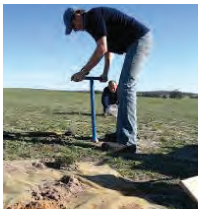
شکل ۱۲. استفاده از اوگر برای ساختن سوراخ
