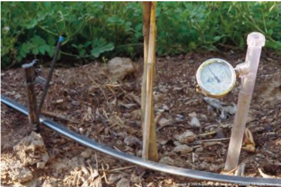
شکل ۱۱. نحوه قرار گرفتن تانسئومتر در آبیاری قطره‌ای
