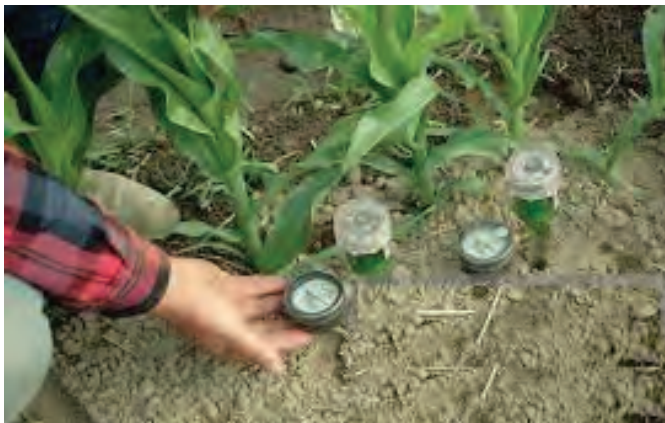
شکل ۶. اندازه‌گیری رطوبت خاک با تانسیومتر
