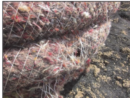
الف) سوراخ شدگی لوله زهکش و پوشش دور آن
