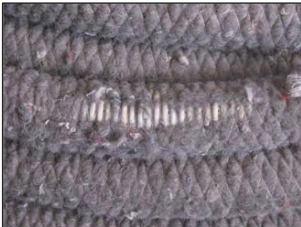
ب) جابه‌جایی و حذف پوشش مصنوعی از روی لوله زهکش
