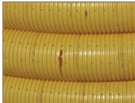
ج) شکستگی لوله زهکش در هنگام حمل و نقل
