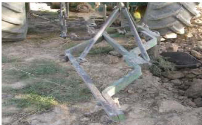
شکل ۴- برداشت پیاز زعفران با استفاده از گاواهن برگردان‌دار تک خیش
