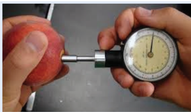
شکل ۴- اندازه‌گیری میزان سفتی میوه هلو با پنترومتر دستی
