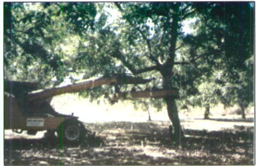
شکل ۲- دستگاه برداشت مکانیکی گردو
