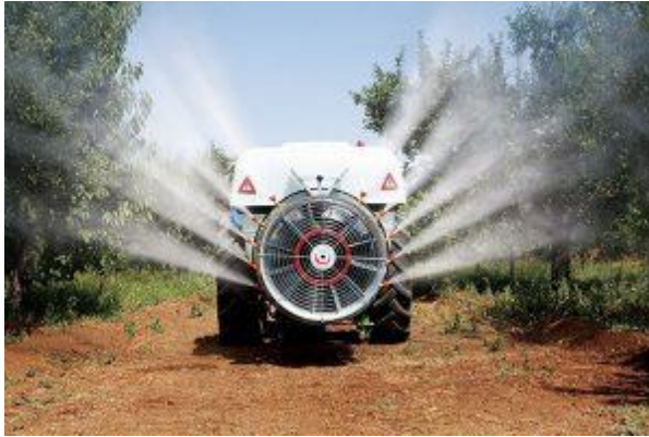
شکل ۲۱- سمپاش توربینی باغی در حال کار
