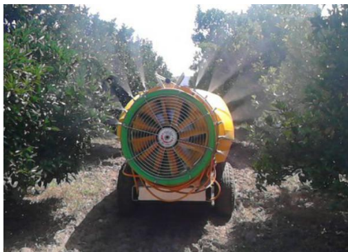
شکل ۱۸- موقعیت توربین و نازل‌ها در سمپاش توربینی
