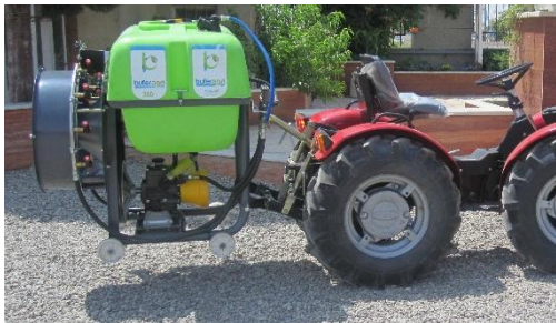
شکل ۴- سمپاش توربینی باغی سوارشونده
