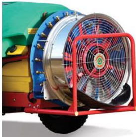
شکل ۱۷- بوم نیم‌دایره‌ای و نازل‌های روی آن
