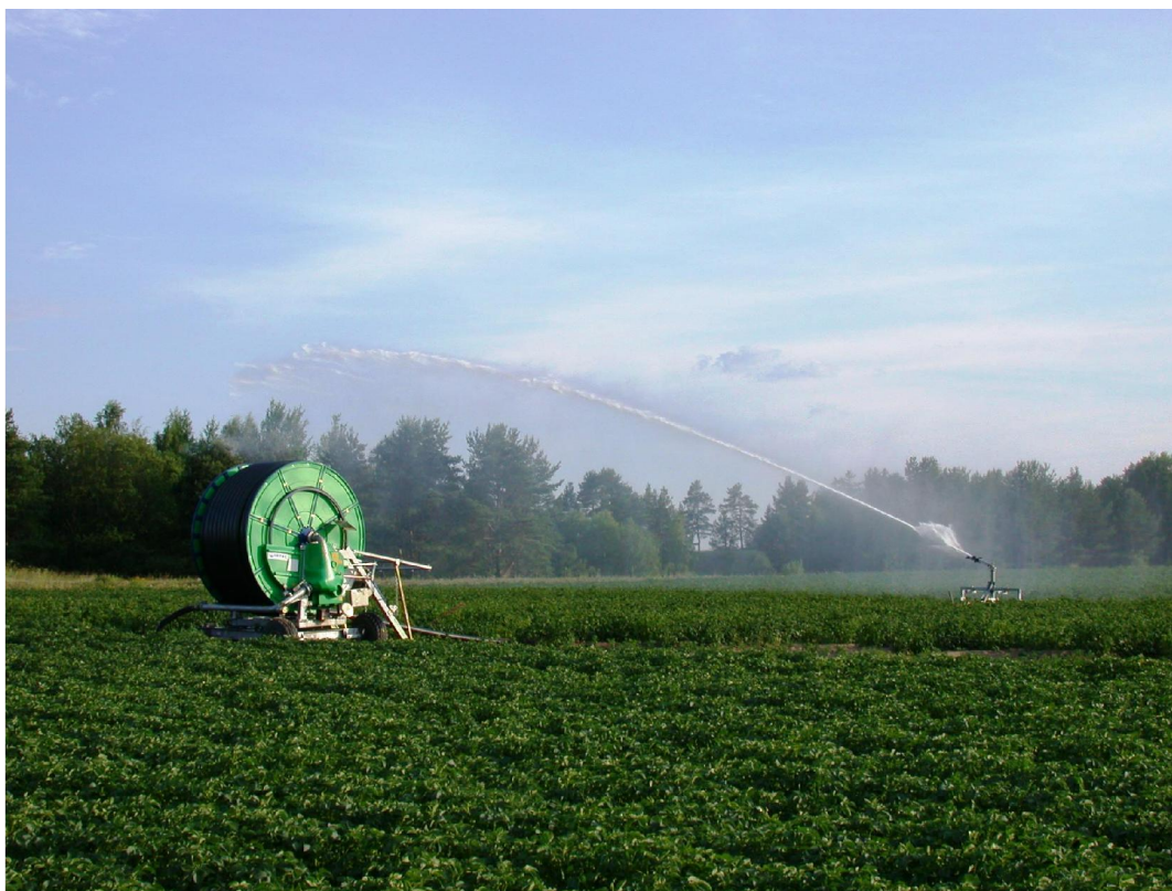
شکل ۷- سیستم آبیاری قرقره‌ای (گان)
