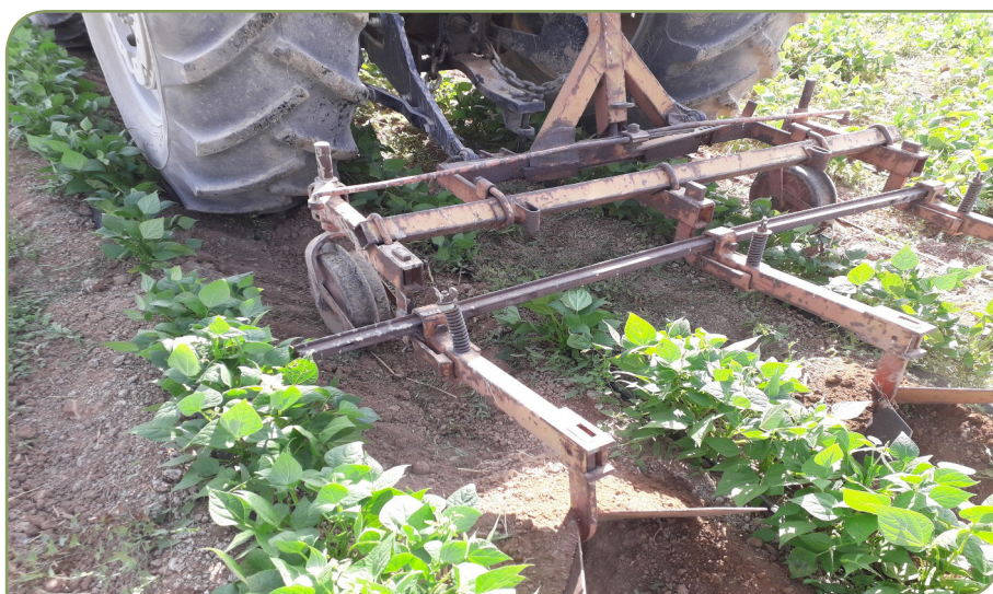
شکل ۲- وجین کن بیلچه‌ای عریض برای وجین لوبیا با فاصله ردیف ۷۵ سانتی‌متر
