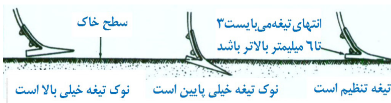
شکل ۸- تنظیم زاویه نفوذ
