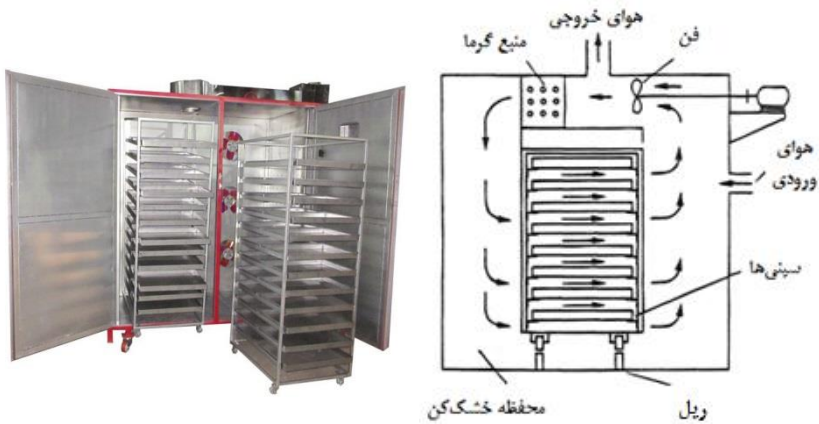
شکل ۱- شماتیک و تصویر خشک کن هوای داغ صنعتی
