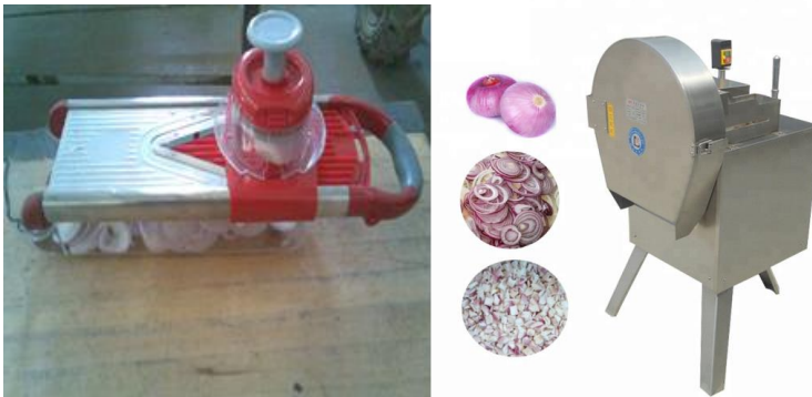
شکل ۱۲- دستگاه‌های سمت راست و چپ به ترتیب اسلایسر صنعتی و دستی پیاز
