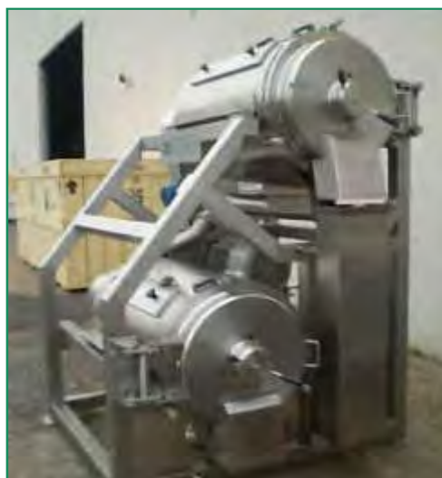
شکل ۶- دستگاه تصفیه دو مرحله‌ای
