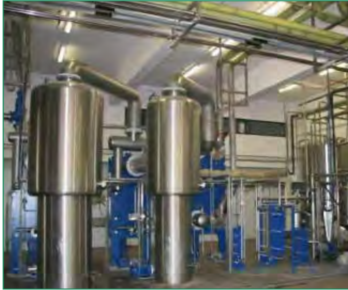
شکل ۹- دستگاه تبخیرکننده (اواپراتور) صفحه‌ای سه‌مرحله‌ای
