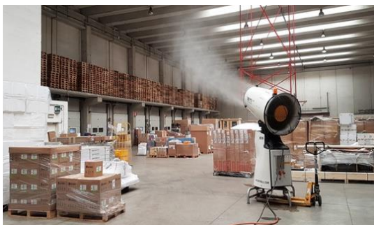
شکل ۳۵- استفاده از هوای گرم و بخار آب برای ضد عفونی کردن انبار (عکس از: https://www.anbaronline.ir/p/11267 )
