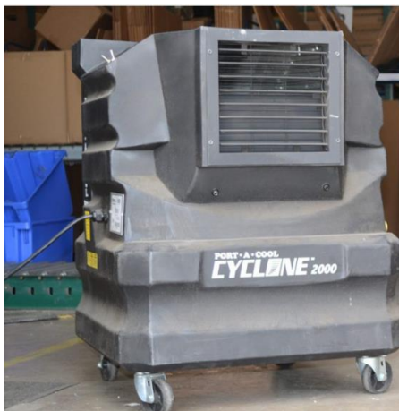
شکل ۳۰- نمونه ای از دستگاه کولر آبی بزرگ مخصوص انبارها (عکس از: http://garماسard.com )
