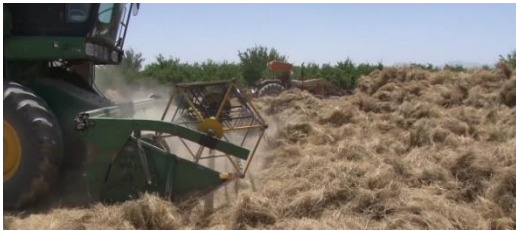
شکل ۸- استفاده از کمباین غلات برای کوبش زیره سبز (عکس از سعیدی راد)
