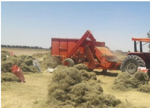
شکل ۹- کوبش زیره سبز با استفاده از خرمنکوب پشت تراکتوری (عکس از سعیدی راد)
